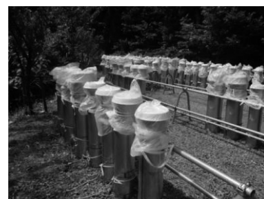
花火を打ち上げる筒 (雨が入らないように洗面器をかけビニールで覆われている)
